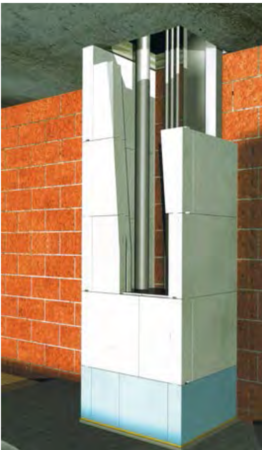
Exemple de construction d'une gaire de ventilation
