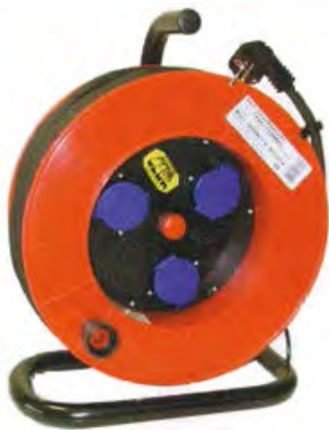
Enrouleur Câble néoprène – 40 m: 3 x 2,5 mm 2 Prise avec 3 caches: 2P + terre Avec interrupteur thermique Degré de protection: IP44 Photo: SWINKO
