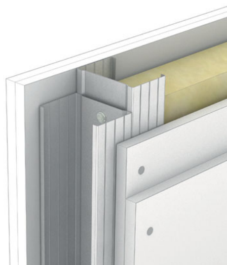
Doublage des montants
