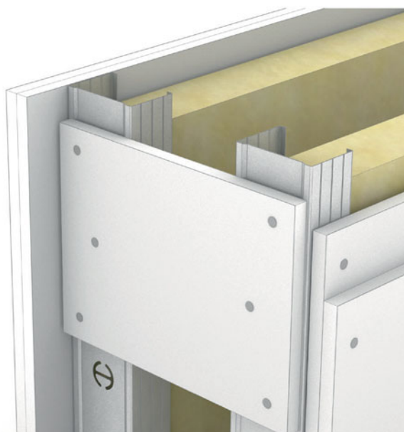
Ossature double accouplée avec montants simples.
