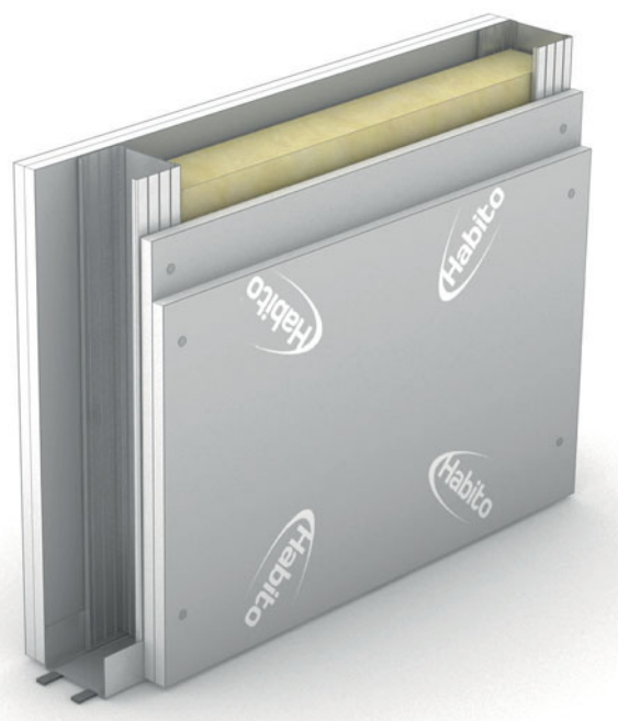
RC2 : entraxe des montants 600 mm, 2 x Gyproc® Habito® 12,5 mm
