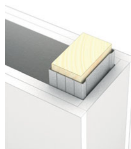
3) Pose d'une latte de renfort en bois dans le MSV
