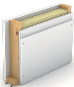
Habillage de la structure portante
